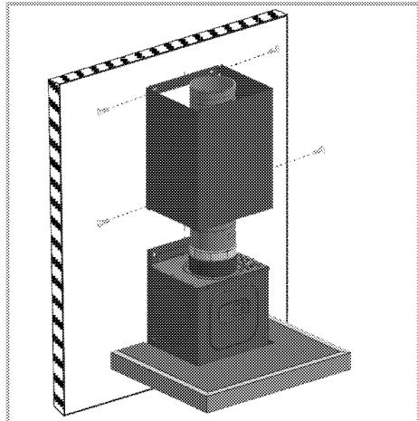
Para instalar la chimenea inferior, ensanche la chimenea tirando suavemente de ambos lados y fíjela a las ranuras de la chimenea superior tal como se muestra en la figura anterior.
