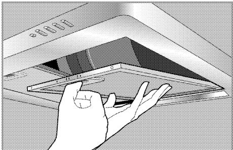
10. Instale el filtro de carbono tal como se muestra en la siguiente imagen.
