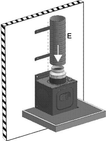
Asegúrese de que los tubos de conexión de la chimenea sean de material plástico ignífugo. Al usar una tubería de conexión flexible, debe tenerse en cuenta que las esquinas pronunciadas y las contracciones súbitas tendrán un efecto negativo sobre la succión de aire.
