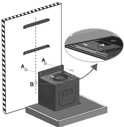
5. Conforme ilustrado na figura abaixo, coloque a cobertura (C) - que impede o fluxo inverso do ar - na saída da chaminé.
