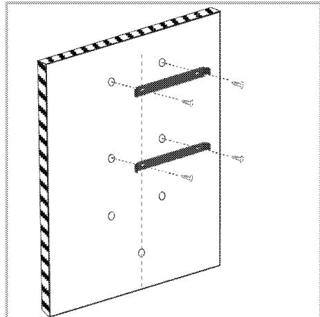
3. Podle obrázku výše upevněte stěnový kus do příslušných otvorů, pomocí dvou upevňovacích šroubů, které jsou součástí balení.
