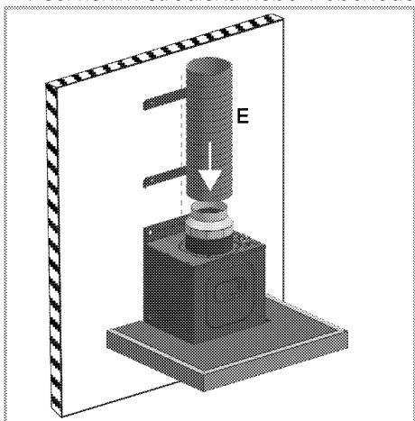
Potrubí kouřovodu by mělo být vyrobeno ze žáruvzdorného plastového materiálu. Při použití flexibilního spojovacího potrubí mějte na vědomí, že ostré rohy a zúžení budou bránit plynulému nasávání vzduchu. Digestor se nikdy nesmí připojovat ke komínu, do kterého je vyvedeno jiné zařízení.
