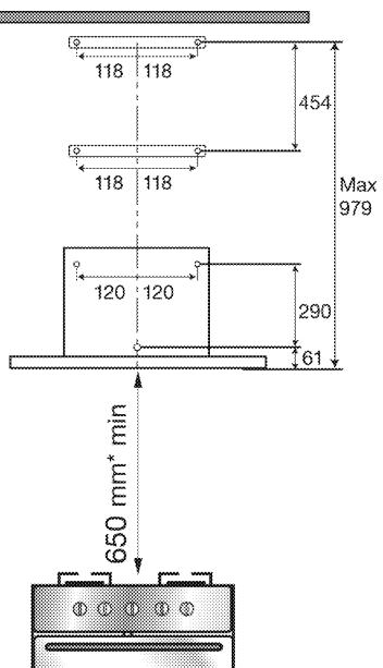
1. Spotřebič vycentrujte a na stěnu vyznačte osu o výšce uvedené na obrázku výše. Tuto osu použijte jako referenční a podle výše uvedených rozměrů vyvrťte otvory o velikosti podle hmoždinek, které najeznete v balení.
